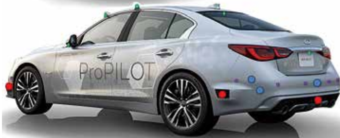
●レーダー(9個) ●カメラ(12個) ●レーザーสキャナー(6個) ●ソナー(12個)
