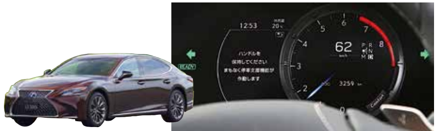
レクサス「新型LS」に搭載されたドライバー異常時停車支援システム(LTA連動型)をテストコースで体感した。76km/hで走行中にドライバーが意識を失ったことを想定。無操作状態から約50秒後から16秒かけて46km/hへと減速しつつ途中57秒後からはハザードランプを点灯。そして1分7秒後にはホーンを断続的に鳴らしながら、1分21秒後から13秒かけて0km/hまで減速。今回は、無操作状態から1分34秒後に自動停車した。
