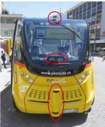
写真③ 車両に備えられている全方位レーザーセンサー（上部、下部）と複眼光学式カメラセンサー（中央部）
