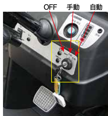
写真④ キーを差し込んで、手動・自動を切り替える。
