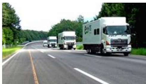
通信によって走行状況を共有し、先頭のトラックに後続の無人のトラックが付き従って走る「隊列走行」実験。
