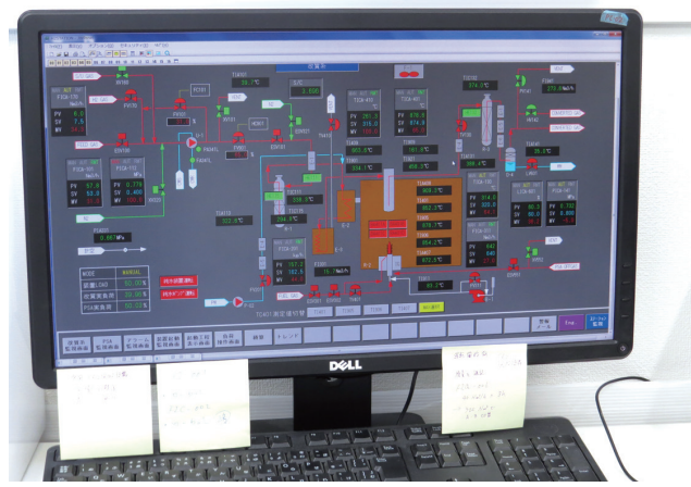
写真④ 水素製造のすべての工程を管理するモニター。日本では専門有資格者(高圧ガス取り扱い資格者)が必要 *本記事掲載号・No.40の『海外交通事情報告』ご参照
