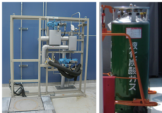
写真③ 液化CO 2 を充填するための設備(左)と出荷用ポンペ(右)
