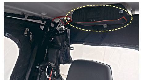
写真③ 2人以上で利用する場合にはインカムあるいは取り付け型マイクのレンタルがあり、運転中に仲間と無線で話ができる。点線内は他車から受信した音声を流すスピーカー
