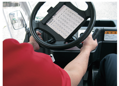
写真⑥ 自動走行中、ドライバーはハンドル下のバーに手を添えている。緊急時にドライバーがハンドルを握ると即時マニュアル運転に切り替わる
